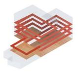
frente a la rotundidad de la forma del edificio, la caja escénica se presenta como un espacio de libre configuración, formado por cuatro cuadrantes compuestos por plataformas hidráulicas que dan lugar a diferentes configuraciones\_
