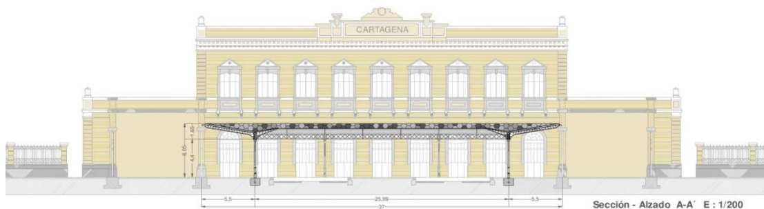
Alzado Sección Longitudinal Marquesina
