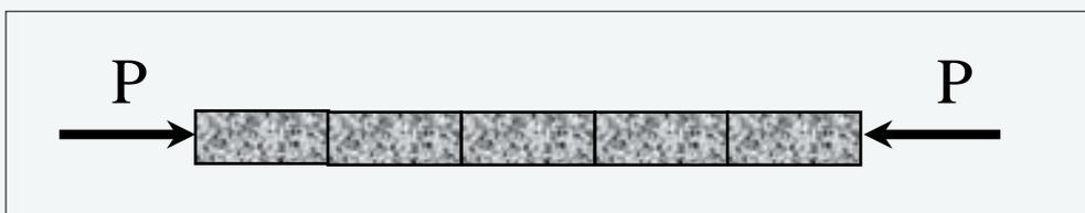
*Figura 2. Elemento sometido a compresión. Elaboración propia*
