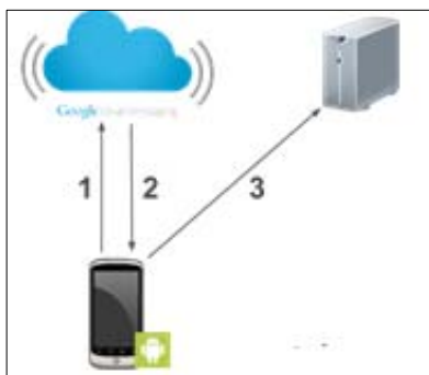
Fig. 4.4.2 - 1 Esquema de comunicación entre el dispositivo móvil y el servidor GCM. Fuente: http://developers.google.com
