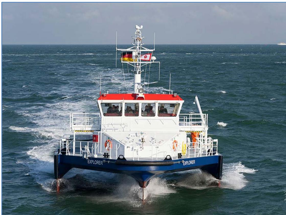
*Ilustración 14. Buque offshore tipo swath. Fuente: [www.mtu-report.com](http://www.mtu-report.com)*
