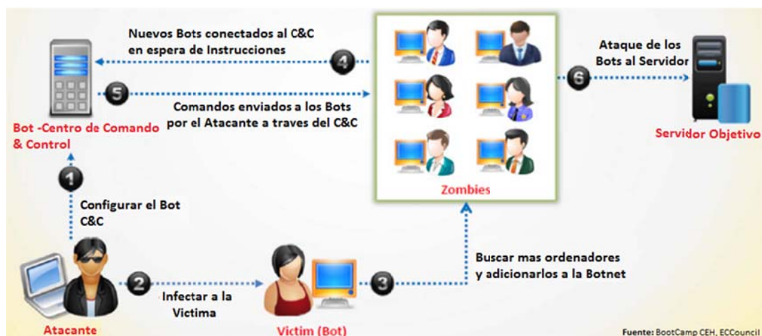
Figura 4: Proceso de creación de una botnet
