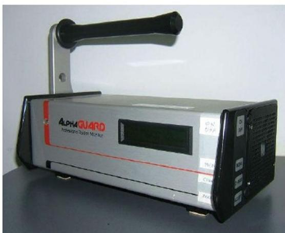
*Figura 5.1. Equipo detector para medir Gas Radón en continuo, modelo “AlphaGuard”*
