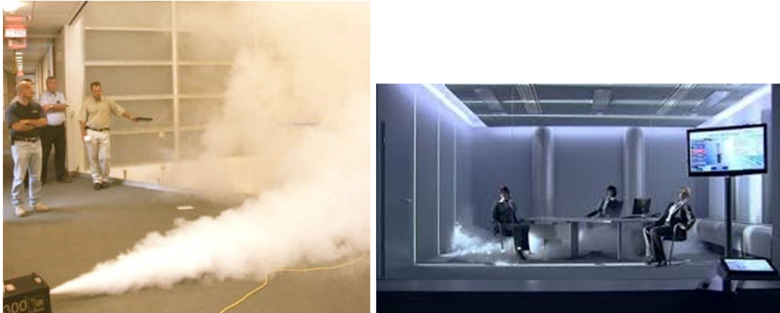
Figura 5.4. A medida que se dispersa el humo podemos observar cómo es evacuado por la ventilación.
