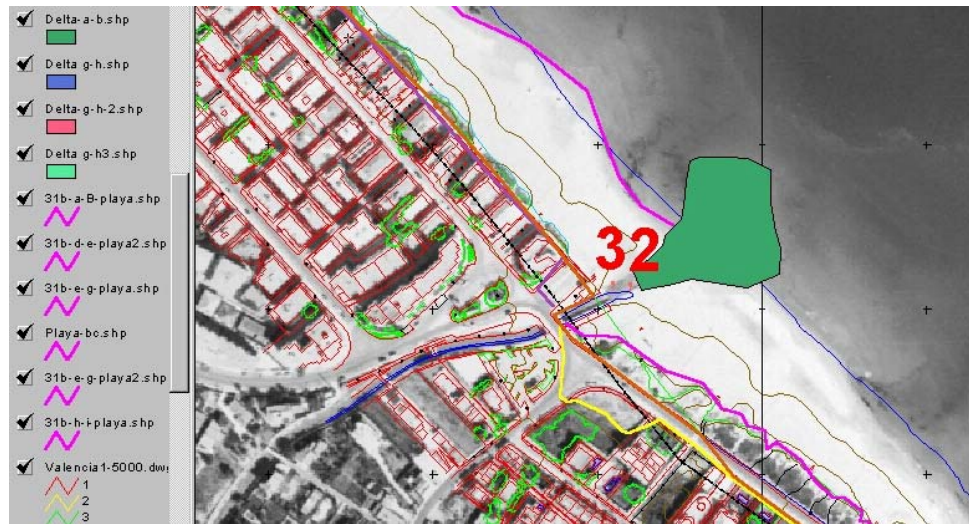
Figura 12. Aplicación de alguna herramienta GIS (en este caso Arc/view) para delimitar la interpretación geomorfológica con polígonos digitalizados y georeferenciados.
