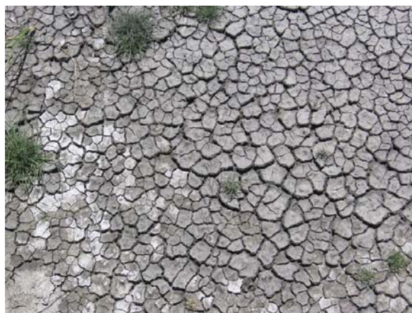
Figura 4. Variaciones en la permeabilidad vertical por efecto de la acumulación de finos e inicio de procesos colmatantes. Fondo de la balsa del Sanchón (sector central de la Cubeta). 19 de mayo de 2006.
