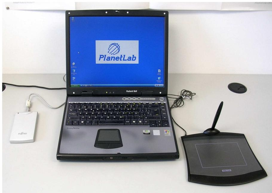
Figura 1: Ejemplo de los reducidos recursos (hardware) necesarios para la creación de un sencillo laboratorio para la investigación en Geología Planetaria: un equipo informático con un dispositivo externo de almacenamiento y una tableta de digitalización para las tareas de cartografía.
