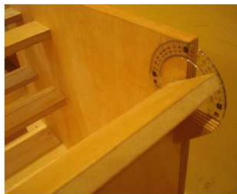
Figura 17: Goniómetro, que permite fijar el ángulo que forma la pieza con la horizontal.
