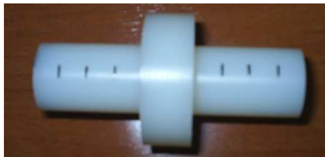
Figura 4 Planteamiento de ensayos sobre las probetas: a) Esquema, b) Probeta tipo (Fuente: Elaboración propia)
