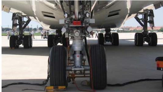
Figura 10. Configuración del tren de aterrizaje de un Airbus A-380 [17].
