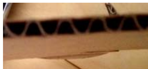
Figura 3.2 Ondas tipo C de 4mm
