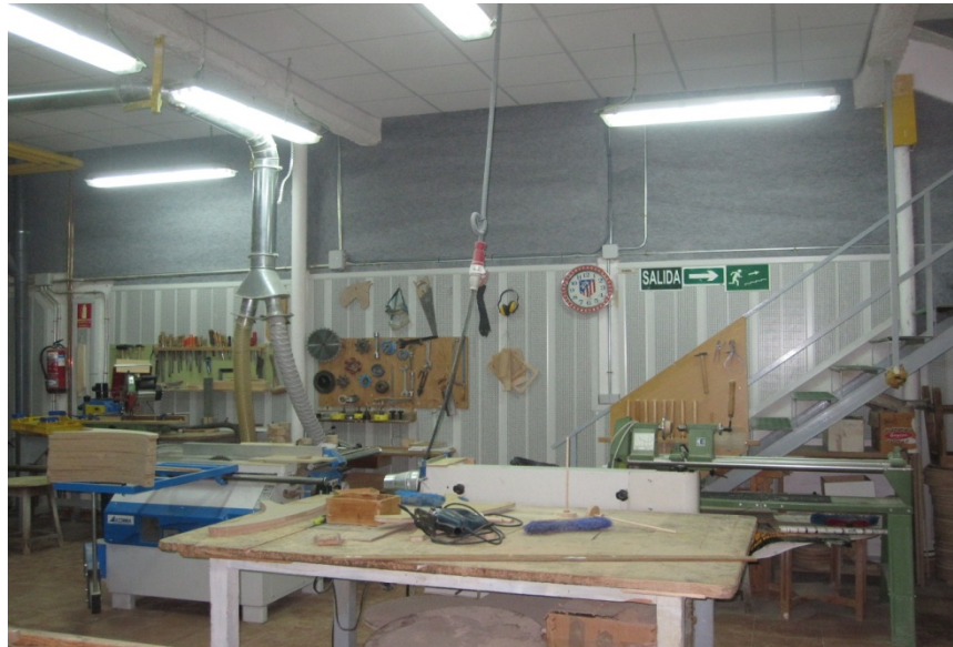
Figura 3.5: Detalle de una de las paredes laterales del taller de ebanistería acondicionada en su parte inferior con Acustisón y en su parte superior con Acustifiber.
