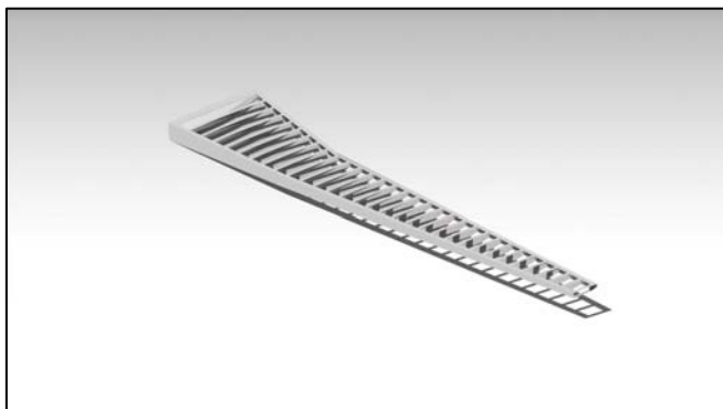
Figura 5.2 Cajón de torsión generado por el modelo para el ala anteriormente generada.
