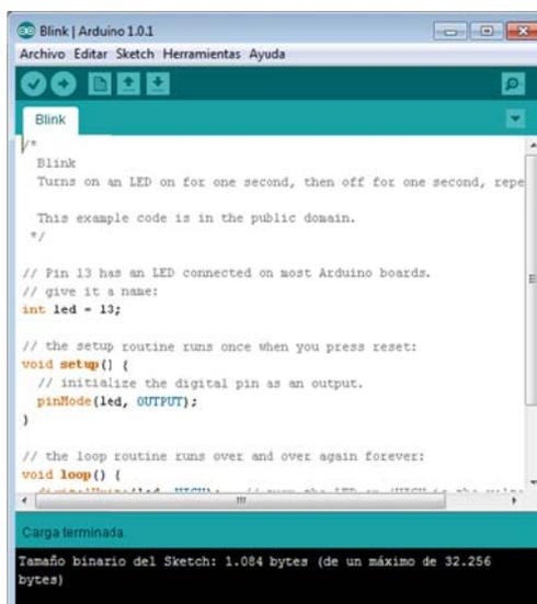
Fig 3.2 Edición de un programa en el entorno de programación
