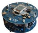
**Arduino robot.** Es un sistema completo en forma de robot, con dos placas Arduino: una de control y otra de motores, basadas en el procesador ATmega32u4, por lo que son similares a la placa Leonardo. Incluyen varios sensores y actuadores: dos potenciómetros, cinco pulsadores, un compás digital, cinco sensores de suelo, altavoz, dos motores, una pantalla LCD de color, lector de tarjetas SD.<sup>38, 39</sup>
